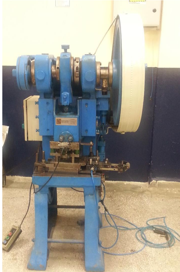
Şekil 3. 40 ton kapasiteli eksantrik pres (pnömatik sürücülü)
