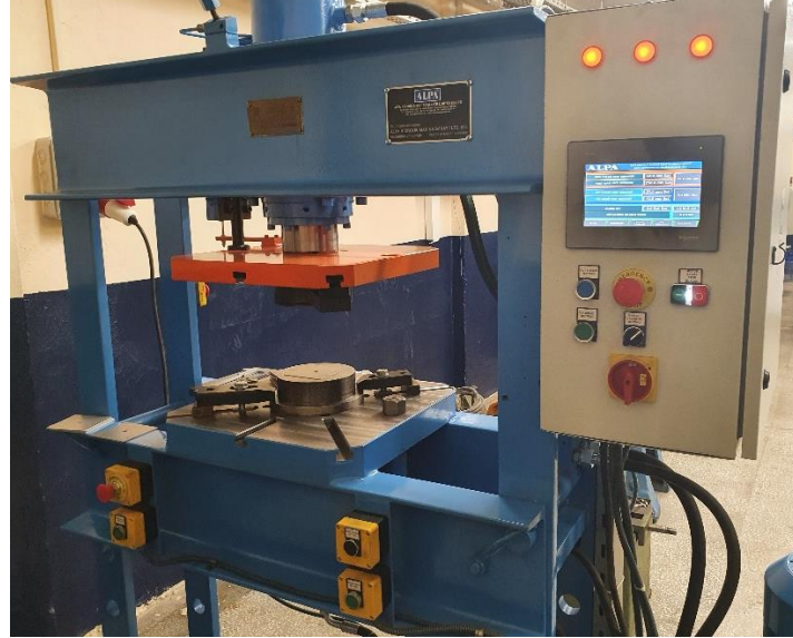
Şekil 1. 30 ton kapasiteli ve PLC kontrollü hidrolik pres
